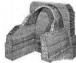
نحوه اجرای طاق گهواره‌ای
